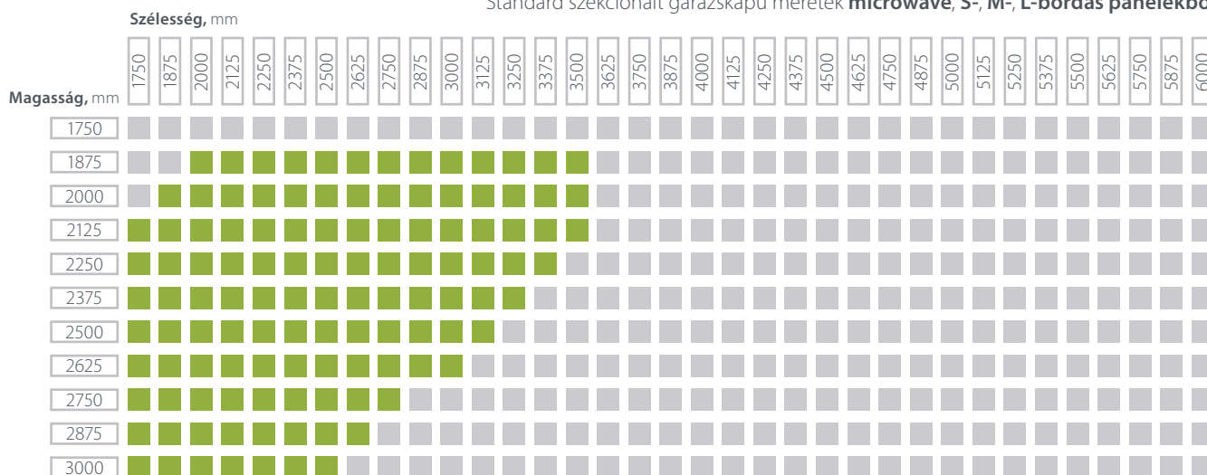
Standard szekcionált garázskapu méretek microwave, S-, M-, L-bordás panelekből
